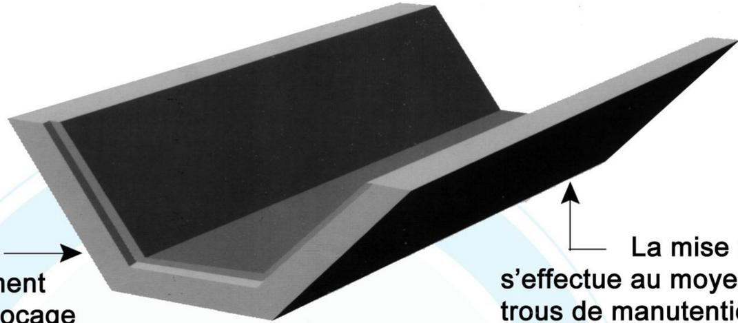
Les extrémités des caniveaux sont pourvues d'un emboîtement mâle-femelle qui permet un blocage transversal des caniveaux lors du compactage du remblai.
