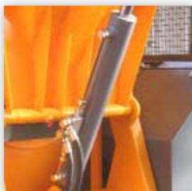
Avec clapet piloté permettant le blocage du chargeur en toute position.
