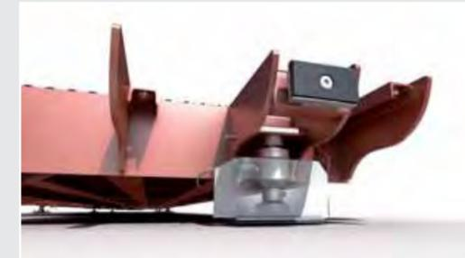
Les capteurs de charge sont équipés de supports oscillants en acier inoxydable qui permettent d'éliminer toute source de dommages causés par des forces latérales. Ils sont également équipés d'un dispositif de protection électrique contre les surtensions qui réduit considérablement le risque de dommages (ex: foudre).
